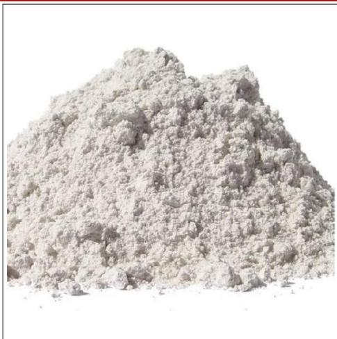
Microsilicatos seleccionados (Silica-fume) para la fabricación de conglomerados de alta densidad y prestaciones (impermeabilidad, estabilidad química, resistencia mecánica etc.), para la fabricación de morteros, revoques, micro hormigón y hormigones sulfato-resistentes, anti derrubiado.
