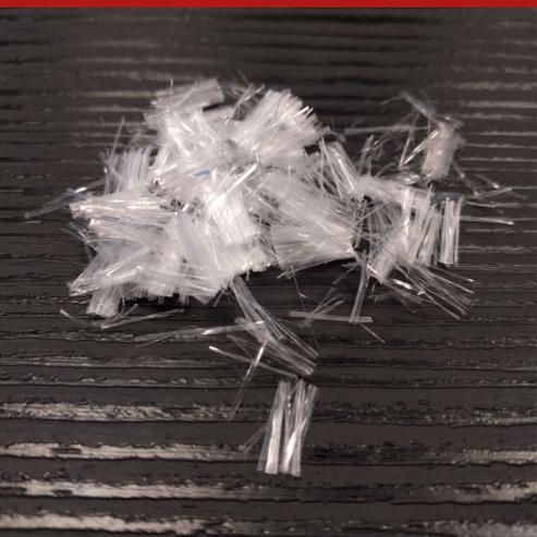
Readymesh PW-120 es una micro-fibra auxiliaría fibrilada, de largo igual a 12 mm, idónea para la adición en conglomerados cementicios en general. El añadido de Readymesh PW-120, a la mezcla permite de contrastar el fenómeno de las fisuraciones por retracción plástica del hormigón, además de tener efectos positivos en la ductilidad de la mezcla, la resistencia al hielo/deshielo, la resistencia a los choques y la impermeabilidad total.
