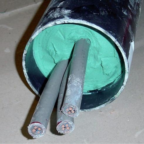
Compuesto sellante, monocomponente, permanentemente plástico, ligeramente expansivo (+10% en volumen en contacto con el agua), para impermeabilizar agujeros subterráneos, mediante los cuales pasan uno o más cables y/o tubos técnicos, en las estructuras de muros. Se aplica alrededor de los cables viandantes, mediante específica pistola dosificadora para bolsitas de 600 ml, y posteriormente recubierto con mortero tixotrópico Repair Tix G2.
